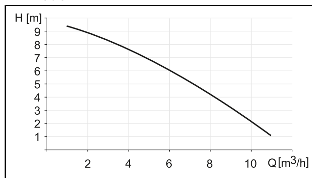
Rys.: Wydajność tłoczenia Q i wysokość podnoszenia H
