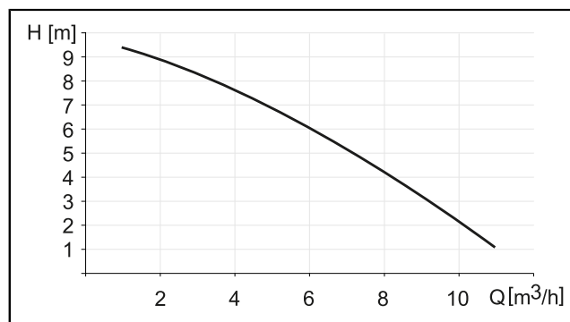
Fig.: Débit Q et hauteur de refoulement H
